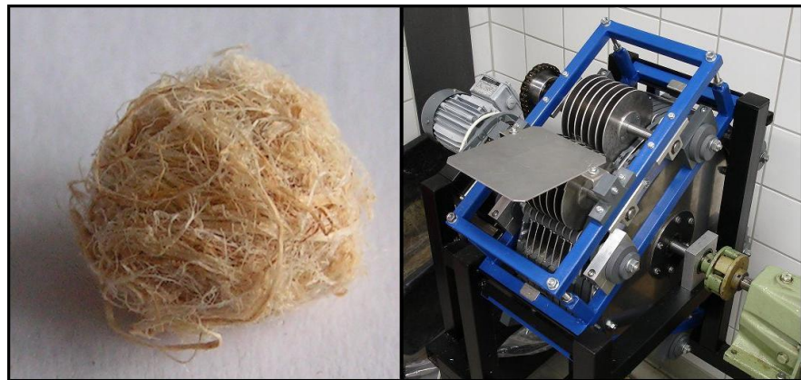
Rollagglomerat aus 100% Hanffasern (links) und eine Vorrichtung zu ihrer Herstellung (rechts)
